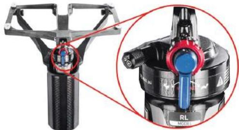
La suspensión neumática puede entregarse de manera opcional con una pequeña palanca que permite bloquear fácilmente la suspensión en el caso de que se necesite que la silla sea rígida al 100%. Sin embargo, debido al diseño de la base del asiento, experimentará que no se produce una pérdida de energía en la propulsión hacia adelante, incluso en el caso de estar beneficiándose de la suspensión, esta eficiencia en la propulsión no se verá afectada.
